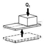
50% de la carga nominal (carga máxima) distribuida de manera uniforme por la mitad de la longitud de la plataforma.
