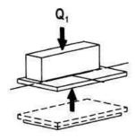
33% de la carga nominal (carga máxima) distribuida de manera uniforme por la mitad de la anchura de la plataforma.
