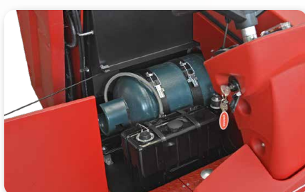
Impianto GPL LPG system Instalación de GLP
